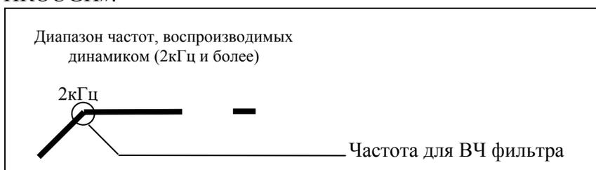
Когда ВЧ фильтр установлен на отметке «THROUGH», НЧ фильтр должен быть установлен на «**20кГц**».
